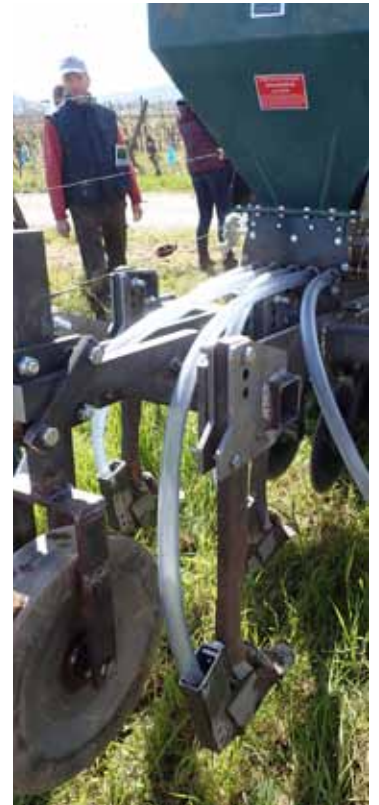
Un semoir direct en engrais verts pour la viticulture
